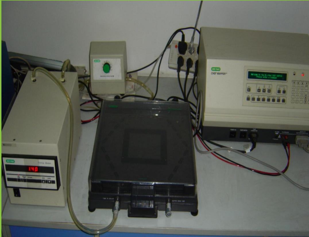
六角形电极的电泳槽，保证矢量电场的自由旋转，比常规的脉冲场电泳提供更高的分辨率，电泳速度和更精确的分离，主要用于基因组DNA的分离分析，大分子DNA的指纹图谱分析及多态性分析等
